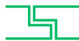
AK-80 Falz allseitig, ab Dicke 35 mm Nutzmass 1988 x 588 mm für alle Produkte
